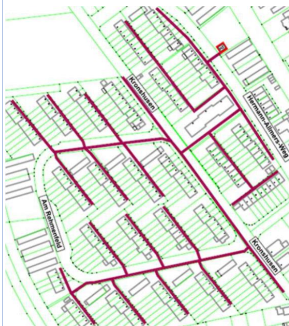
Abbildung 27: Erste Umsetzungsidee zum Nahwärmenetz (Stadtwerke Zeven)
