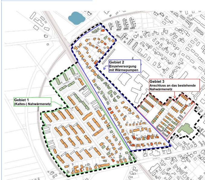
Aufteilung des Quartiers in Wärmeversorgungsgebiete, Quelle: Sweco
